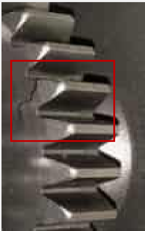
大齿轮裂纹故障
